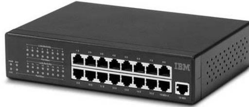
2.33 Figura de un equipo hubs.
