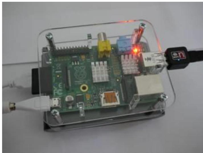
Raspberry PI es una placa de computadora reducida la cual suele ser utilizada para el desarrollo de aplicaciones IOT, esta placa esta compuesta por un procesador Broadcom, memoria RAM, una GPU, puertos USB, HDMI, Ethernet, 40 pines GPIO, un conector para cámara y una Memoria SD o MicroSD.
